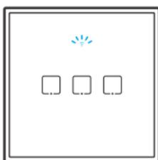
После первого включения устройство перейдет в режим быстрого сопряжения. светодиодный индикатор Wi-Fi начнет мигать в режиме «два раза коротко, один раз длинно».
