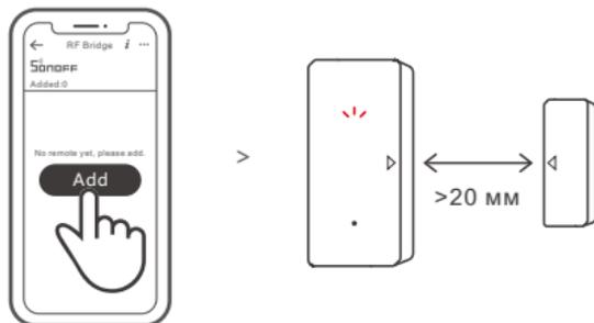
Осуществите доступ к приложению eWeLink и выберите шлюз, коснитесь «Добавить», чтобы выбрать сигнал тревоги. «Зуммер» означает, что шлюз перешел в режим установки соединения. Затем отведите магнит на расстояние более 20 мм от передатчика до момента, когда LED все еще продолжает светиться в течение 1 или 2 секунд. Когда услышите повторяющийся «Зуммер», это означает, что установка соединения завершена.
