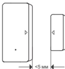
зазор при установке должен быть менее 5 мм, когда закрыта дверь или окно.
