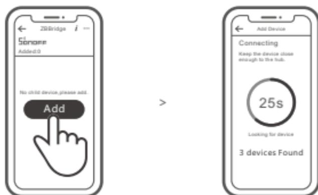
Включите питание шлюза, осуществите доступ к странице шлюза в приложении eWeLink и коснитесь «Добавить». Затем настройте суб-устройство для установки соединения в режиме установки соединения и ждите завершения процесса установки соединения.
