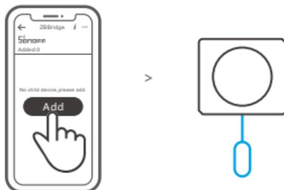
Осуществите доступ к приложению eWeLink, выберите шлюз, который желаете подключить, и коснитесь «Добавить», чтобы добавить суб-устройство. Затем выполняйте долгое нажатие кнопки сброса на устройстве в течение 5 секунд, пока светодиодный индикатор не мигнет трижды. Это означает, что устройство перешло в режим установки соединения, затем ждите завершения процесса установки соединения.
